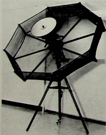
Bild 1. Short-Backfire-Antenne für den Satellitenempfang
