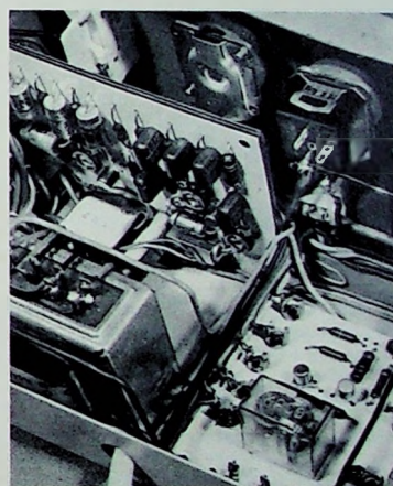
Bild 7. Teilansicht des Chassisaufbaues mit elektronischer Warnsirene und elektronischem Schalter
